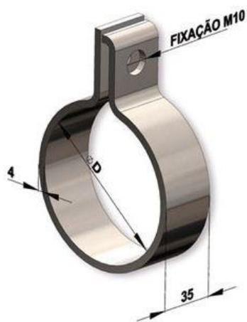
As abraçadeiras do tipo **TIGRE** são utilizadas em conexões entre tubos sem ressalto. São usualmente empregadas nas junções dos sistemas de exaustão de veículos comerciais e de instalações industriais. Fabricadas em fitas de aço carbono estrutural, com isso, possuem grande capacidade de aperto/fixação.
